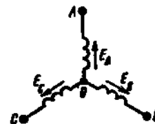
Рис. 6.5. Схема обмоток генератора, соединенных звездой
