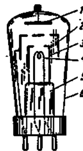
Рис. 15.3. Устройство тиратрона с накаливаемым катодом: 1 — анод; 2 — сетка; 3 — тепловой экран; 4 — катод; 5 — стеклянное основание; 6 — баллон
