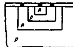
Рис. 21.10. Многослойная структура с тремя p - n -переходами
