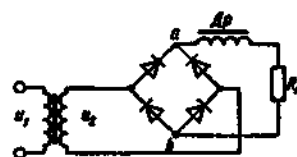
Рис. 18.4. Мостовая схема двухполупериодного выпрямителя
