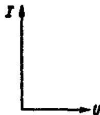
Рис. 5.16. Векторная диаграмма напряжения и тока для цепи с емкостью
