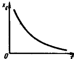
Рис. 5.17. Зависимость емкостного сопротивления X_C от частоты f
