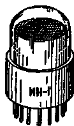
Рис. 15.9. Цифровой газосветный индикатор
