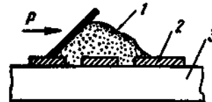
Рис. 21.3. Нанесение пасты на подложку: 1 — паста; 2 — трафарет; 3 — подложка
