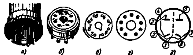
Рис. 14.10. Цоколевка диодов: а — октальный цоколь; б — ламповая панель — октальная; в — нумерация штырьков на октальном цоколе; г — расположение штырьков у бесцокольной лампы; д — двойного диода 6Х6С
