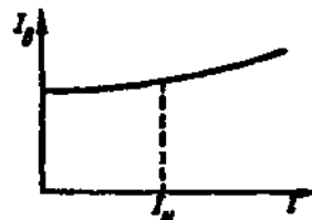
Рис. 9.18. Регулировочная характеристика генератора независимого возбуждения
